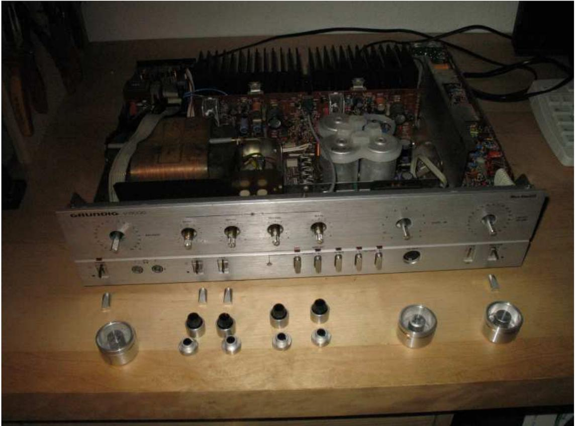
Abbildung 2.4: Nach Abnehmen der Potiknöpfe und Schalterhebel
